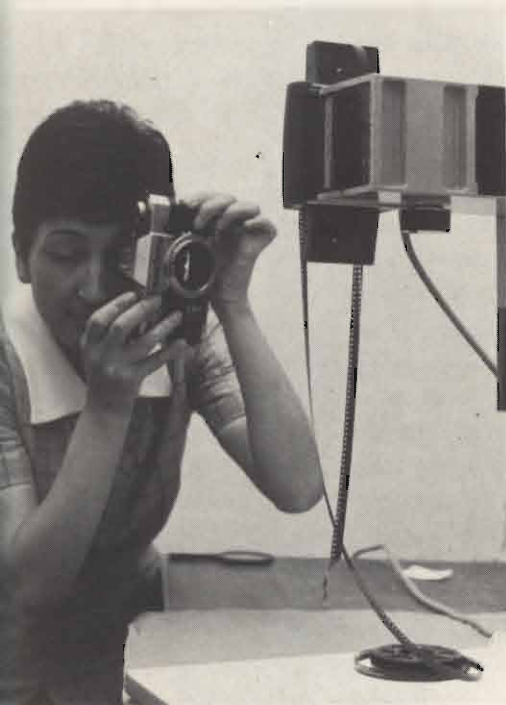
Fig. 2 - E' bene non adoperare la macchina fotografica a mano libera, ma servirsi di un robusto cavalletto insufficiente anche il monopiede che non permette di eliminare le vibrazioni dato il gran numero di ingrandimenti richiesto.
