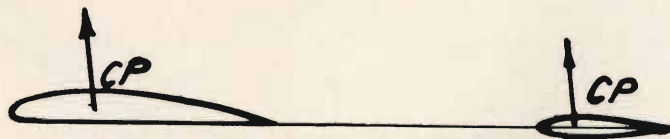
Fig. 4 - Stabilizzatore dimensionato in modo esatto.
