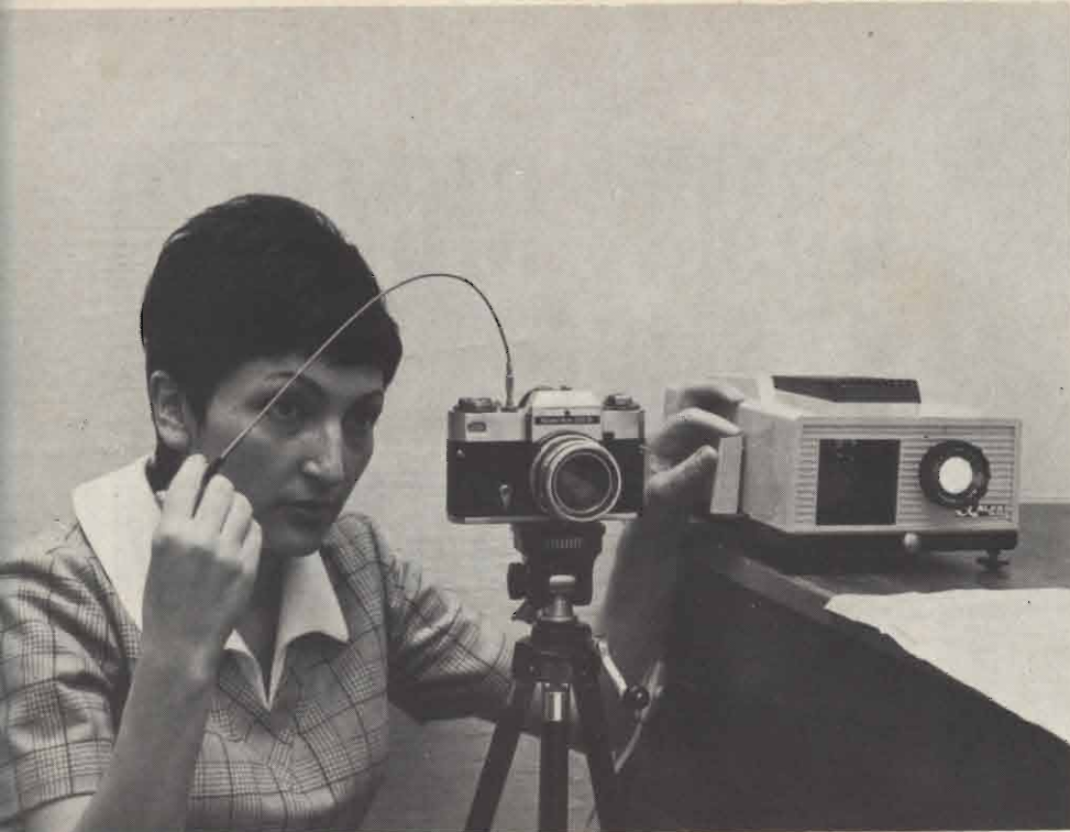
Fig. 1 - Anche col proiettore per diapositive si possono proiettare fotogrammi da film; occorre però tagliare il fotogramma e montarlo sul telaio per dias. La riproduzione si ottiene fotografando l'immagine proiettata: allo scopo può essere usata qualsiasi fotocamera.
